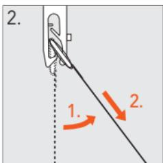
2. Lamellen aus den Lamellenhaken ausklipsen.
