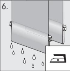
6. Beschwerungsplatten einschieben und Lamellenketten wieder anbringen. Behang mittels Bedienung zum Paket verfahren und unter das Behangpaket gegebenenfalls ein Gefäß zum Auffangen des Tropfwassers stellen. Bei geöffnetem Fenster trocknen lassen. Im Bedarfsfall bügeln.
