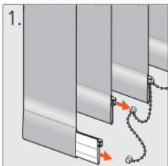
1. Lamellenketten ausklipsen und Beschwerungsplatten aus den Lamellen herausziehen.
