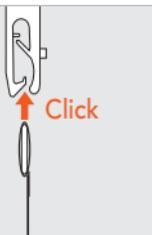
5. Lamellen feucht in die Lamellenhaken einklippen. Bitte beachten Sie, dass die Vorderseiten der Beschwerungsplattentaschen einheitlich in eine Richtung angeordnet werden.
